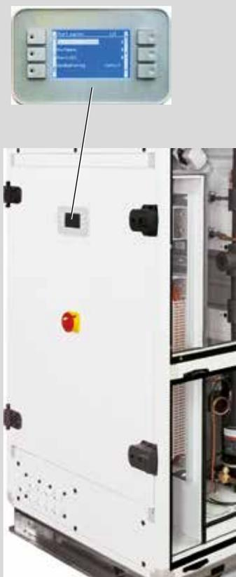
Il sistema di regolazione a microprocessore, installato e cablato in fabbrica, con sezionatore sull'apparecchio, regola e comanda ventilatori, compressore, recupero di calore, temperature, portate volumetriche, orari di funzionamento e molteplici funzioni interne e funzioni di allarme.
